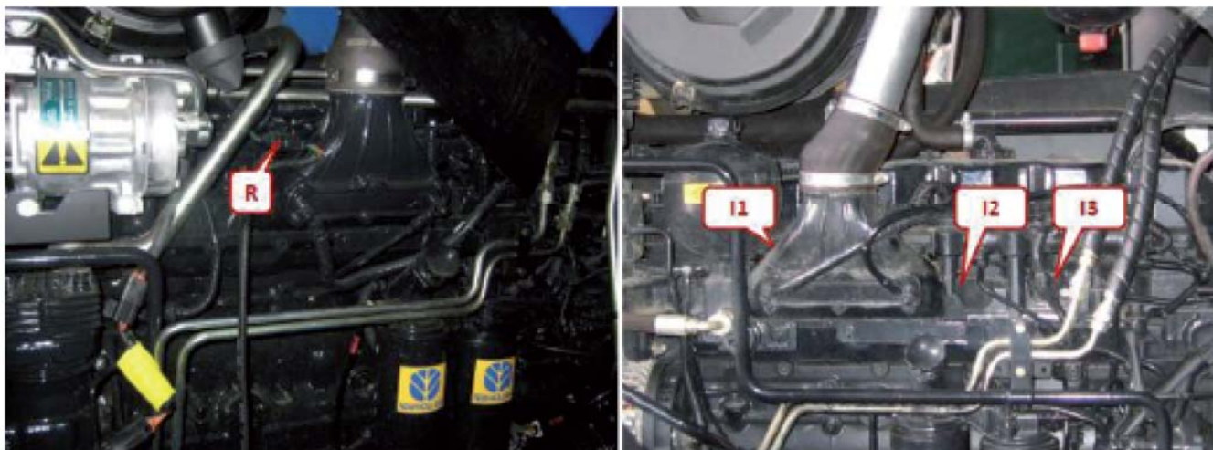
Boxen zijn eenvoudig te plaatsen en in de handleidingen staan zelfs foto's van hoe ze moeten worden aangesloten. Hier een NH tractor met aanduidingen voor de aansluiting op de raildruksensor (R) en de injectoren (I).
