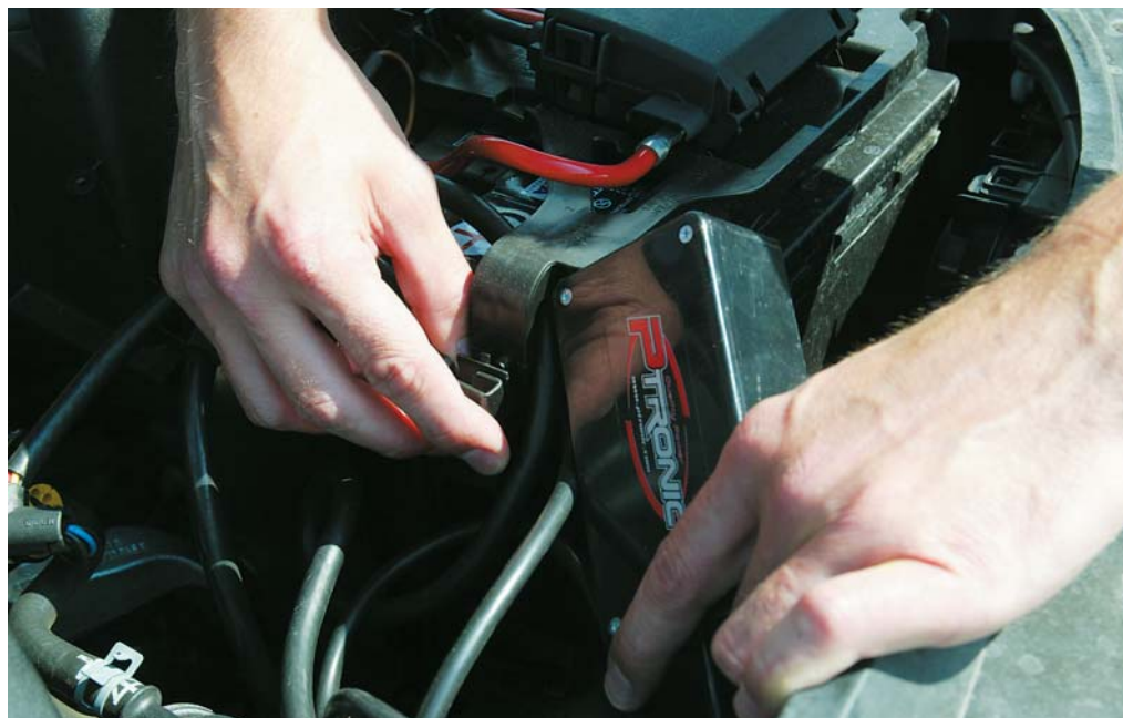
Installer un boîtier additionnel ne demande que quelques secondes, pour autant que la connectique d'origine soit respectée.
